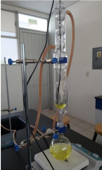
Figura 13. Proceso de extracción Soxhlet.
