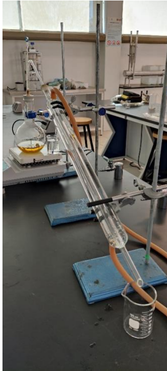
Figura 15. Proceso de destilación simple.
